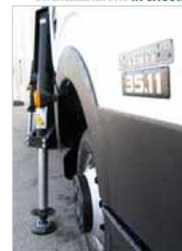
STABILIZZAZIONE IN SAGOMA
